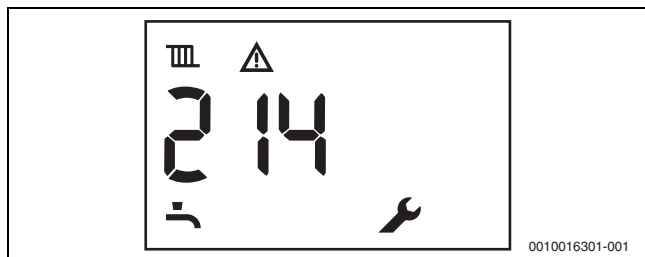
Fig. 93 Exemplu: defecțiune care nu determină blocare
